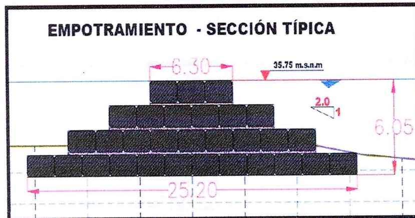
Sección empotramiento espolón de dirección del cauce.
